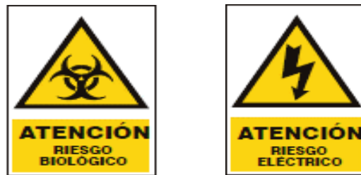
Fig. 4 Señales de peligro en el laboratorio
